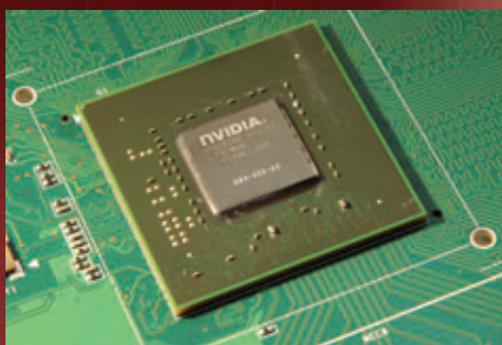
Les puces G84 et G86 sont dérivées du G80 des 8800. Dommage que la mémoire se contente encore d'un bus 128 bits.
