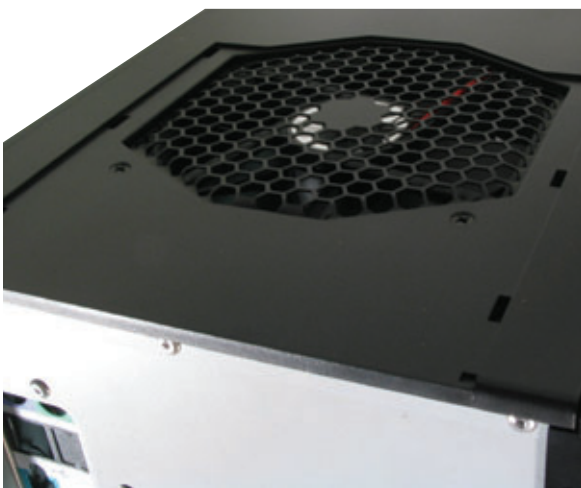
Un ventilateur au sommet du boîtier pourra améliorer la ventilation des configurations chargées.
