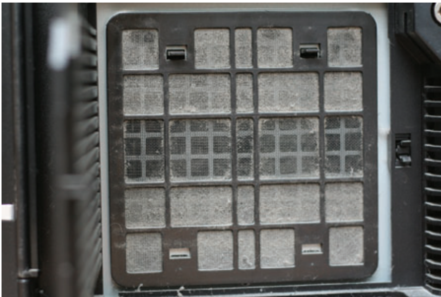
Un filtre nettoyé laissera mieux passer l'air. Illustration ici avec la partie centrale dépoussiérée.
