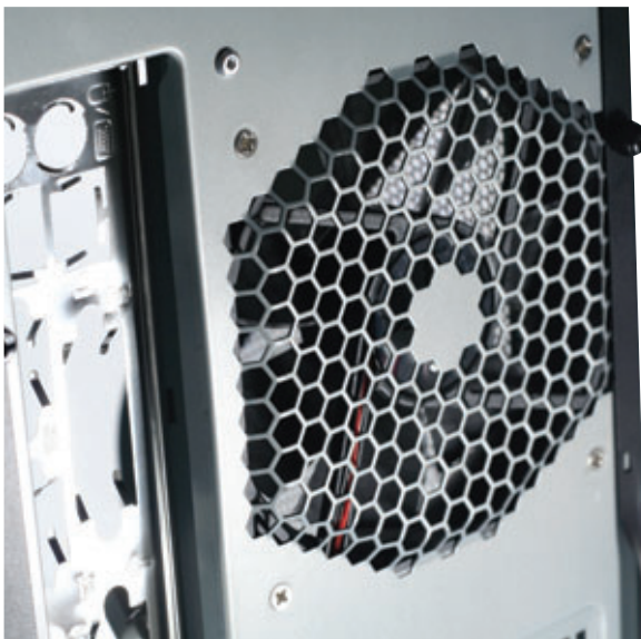
Si'il devait n'en rester qu'un, ce serait celui-là : le ventilateur arrière extrayant l'air chaud.
