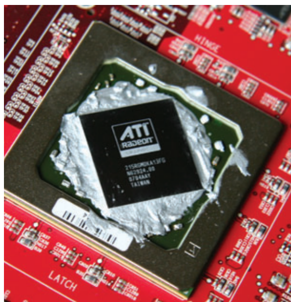
Le R600, malgré ses 700 millions de transistors, ne contient que seize unités de filtrage des textures.
